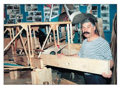
Процесс рождения самолета: большинство деталей машины сделано из дерева!
