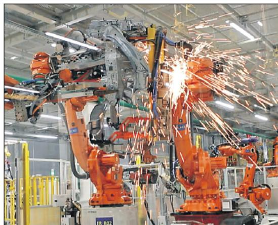
Цех сварки автозавода. 75 роботов без участия человека создают каркас будущей машины.
