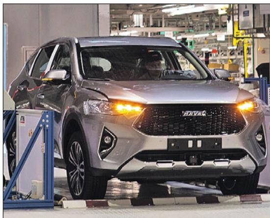
Стенд финальной сборки автомобиля. Каждые 9 минут с него выезжает готовый автомобиль.
